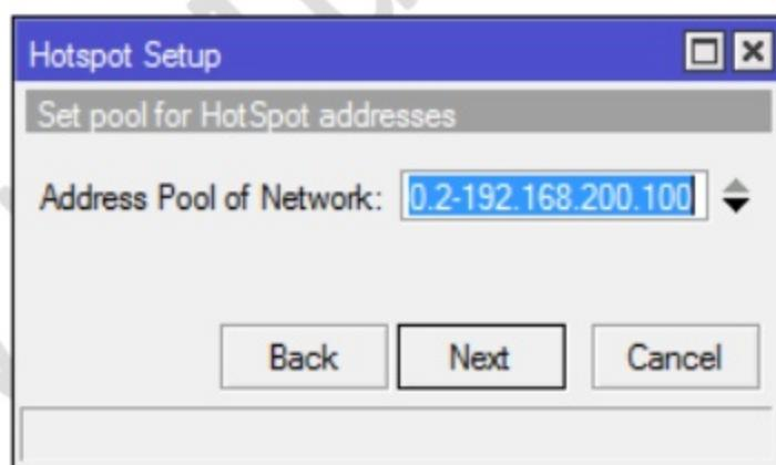
Pada parameter **Address Pool of Network** secara langsung telah terisi dengan rentang alamat **192.168.200.2-192.168.200.100** sebagai hasil dari konfigurasi DHCP Server di langkah sebelumnya. Klik tombol **Next** untuk melanjutkan.
