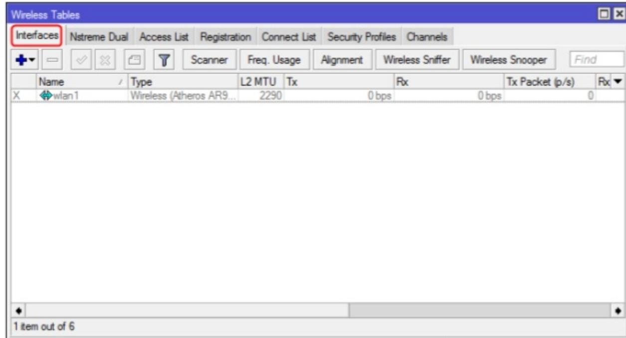
Terlihat terdapat satu interface wireless dengan nama “**wlan1**” dengan status tidak aktif, yang ditandai dengan simbol **X** di awal baris dari interface tersebut. Untuk mengaktifkan interface tersebut, pilih interface “**wlan1**” > klik kanan pilih **Enable** seperti terlihat pada gambar berikut:
