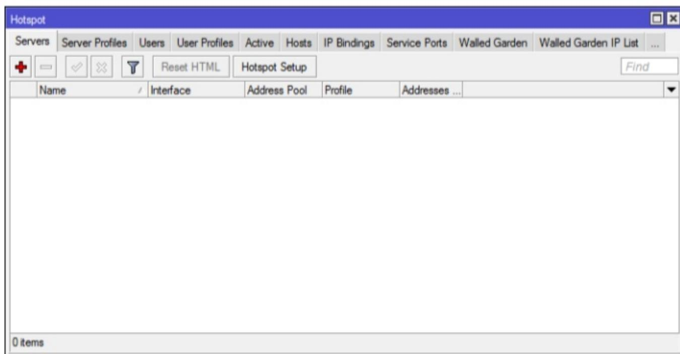
Pada toolbar dari kotak dialog **Hotspot Tab Servers**, klik tombol **Hotspot Setup** maka akan tampil kotak dialog wizard **Hotspot Setup** untuk pemilihan interface, seperti terlihat pada gambar berikut:
