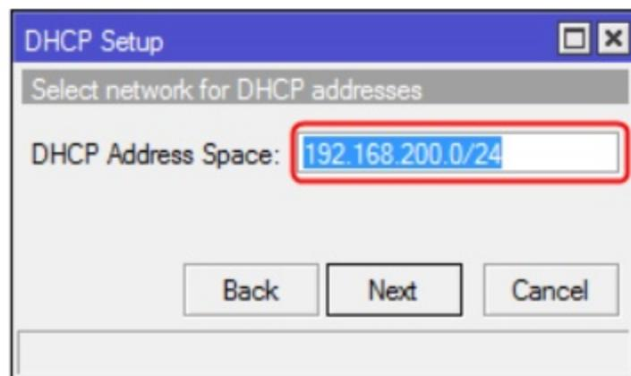
Masukkan alamat jaringan **192.168.200.0/24**, dan klik tombol **Next**. Tampil kotak dialog **DHCP Setup** untuk menentukan alamat *gateway* untuk jaringan DHCP, seperti terlihat pada gambar berikut:
