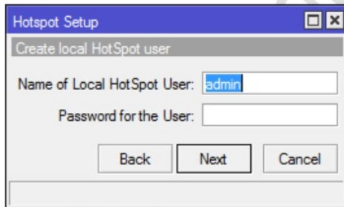
Pada parameter **Name of Local HotSpot User** secara *default* telah terisi dengan nilai "**admin**". Lakukan penggantian menjadi user "**guru**". Sedangkan pada parameter **Password for the User** digunakan untuk mengatur sandi dari *user hotspot* yang dibuat yaitu "**guru**", seperti terlihat pada gambar berikut:
