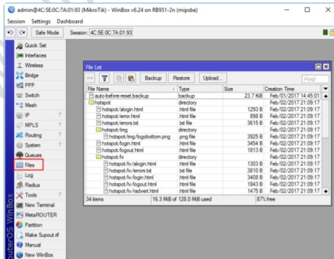
Terlihat file-file yang terdapat pada router. Lakukan download file **login.html** yang terdapat didalam direktori **hotspot** dengan cara **drag and drop** ke komputer, seperti terlihat pada gambar berikut:
