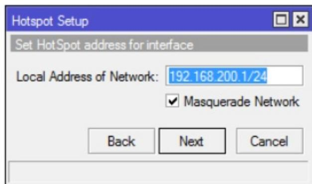
Pada parameter **Local Address of Network** secara langsung telah terisi dengan alamat IP yang telah diterapkan pada interface **wlan1** yaitu **192.168.200.1/24**. Hilangkan tanda cek (v) pada **checkbox** parameter **Masquerade Network**, seperti terlihat pada gambar berikut:
