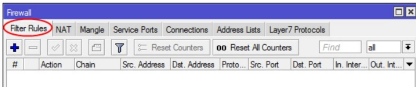
Untuk menambahkan rule baru, pilih tombol pada toolbar dari kotak dialog **Firewall** maka akan tampil kotak dialog **New Firewall Rule** seperti terlihat pada gambar berikut:
