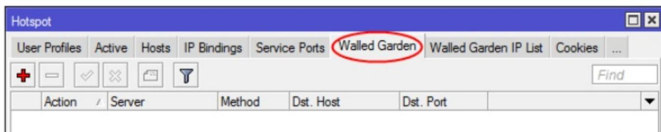
Untuk menambahkan **Walled Garden**, pilih tombol pada toolbar dari kotak dialog **Hotspot**. Pada tab **Walled Garden** maka akan tampil kotak dialog **New Walled Garden Entry** seperti terlihat pada gambar berikut:
