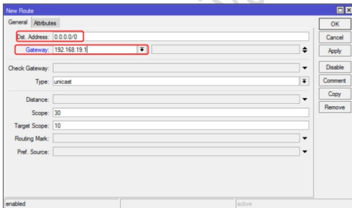
Pada parameter **Gateway** masukkan alamat IP **192.168.19.1 (SESUAIKAN DENGAN ALAMAT IP GATEWAY YANG DIBERIKAN ISP)**. Untuk menyimpan perubahan ketika tombol **OK**. Hasil dari penambahan *default route* ini, terlihat seperti pada gambar berikut:
