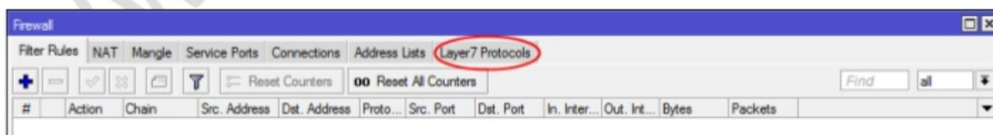
Untuk menambahkan rule baru, pilih tombol pada toolbar dari kotak dialog **Firewall** maka akan tampil kotak dialog **New Firewall L7 Protocol** seperti terlihat pada gambar berikut:
