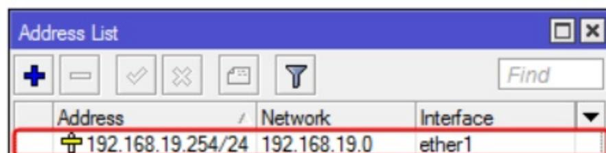
Selanjutnya dengan cara yang sama lakukan penambahan alamat IP pada interface **ether2**, pilih tombol pada toolbar dari kotak dialog **Address List** maka akan tampil kotak dialog **New Address** seperti terlihat pada gambar berikut:
