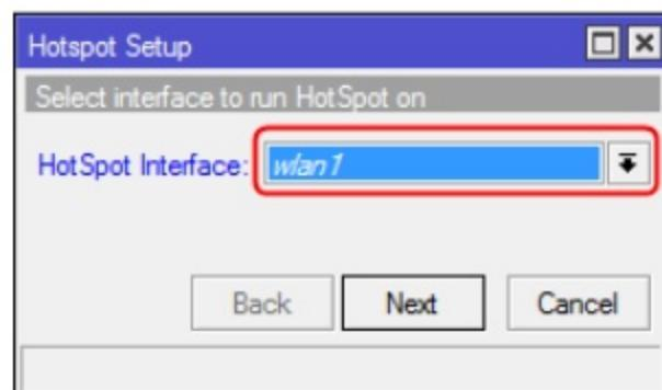
Klik tombol **Next** untuk melanjutkan. Tampil kotak dialog untuk menentukan alamat IP untuk *interface hotspot*, seperti terlihat pada gambar berikut:
