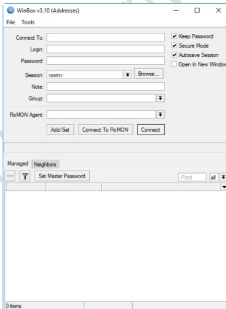
Untuk dapat mengakses Mikrotik, Anda harus melengkapi 3 parameter yang terdapat pada kotak dialog login dari aplikasi Winbox yaitu *Connect to* (digunakan untuk memasukkan alamat IP atau alamat MAC dari router Mikrotik yang akan diakses), *Login* (nama login pengguna yang
