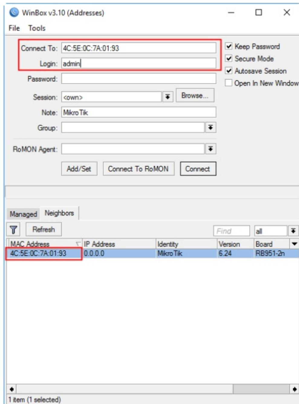
Selanjutnya tekan tombol “**Connect**” untuk menghubungkan ke router Mikrotik.
