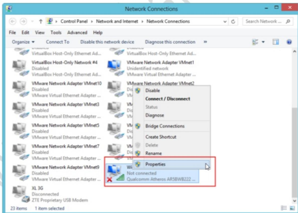
4. Tampil kotak dialog **Wi-Fi Properties**. Pada bagian “This connection uses the following items:”, klik dua kali pada pilihan **Internet Protocol Version 4 (TCP/IPv4)**, seperti terlihat pada gambar berikut:
