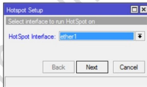
Pada parameter **Hotspot Interface**, pilih interface **wlan1**, seperti terlihat pada gambar berikut:
